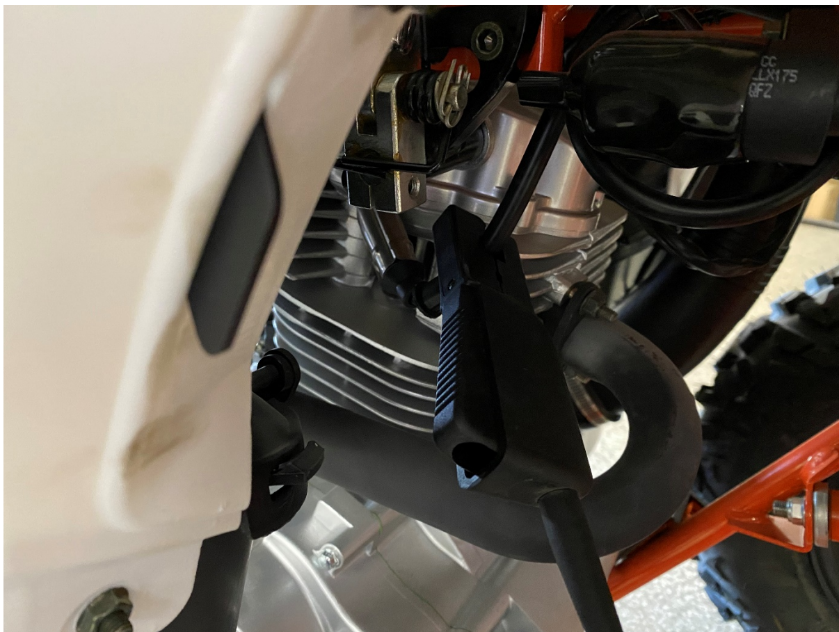
Obr. 5. Pripojenie indukčného snímaču na vysokonapäťový vodič.
