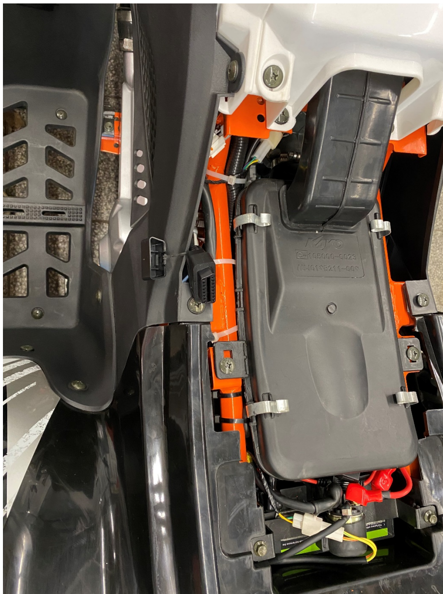
Obr. 2. Umiestnenie 16 pinovej zásuvky OBD na vozidle KAYO AU200.
